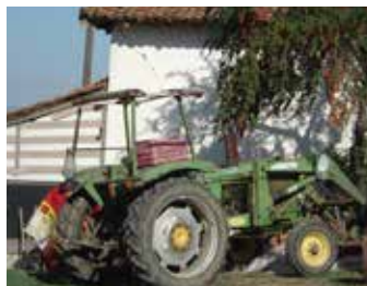
Tractor cu bare de protecție pentru combaterea efectelor răsturnării
