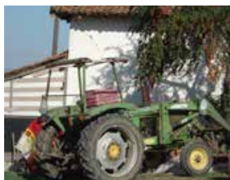
Ciągnik z prętami zabezpieczającymi przed skutkami przewrócenia się pojazdu
