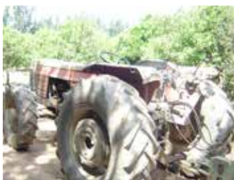
Ciągnik bez zabezpieczenia dla kierowcy
