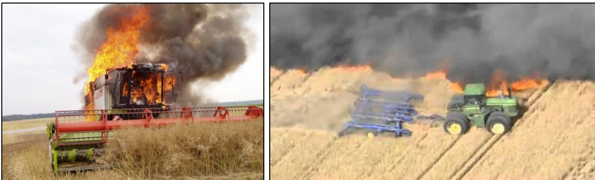
Figura 3 Incendio de una cosechadora de granos en la colza de colza (Černek, 2015 ww.sme.sk ) y mitigación de la propagación del fuego con herramientas de labranza poco profunda ( www.youtube.com )
