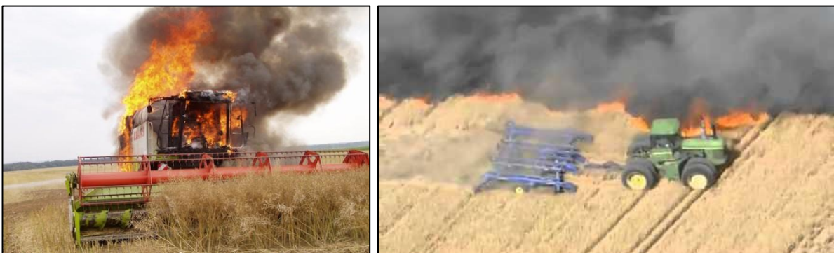
Rys. 3 Pożar kombajnu zbożowego w rzepaku oleistym (Černek, 2015 ww.sme.sk ) i ograniczanie rozprzestrzeniania się ognia za pomocą urządzeń do płytkiej uprawy roli ( www.youtube.com )
