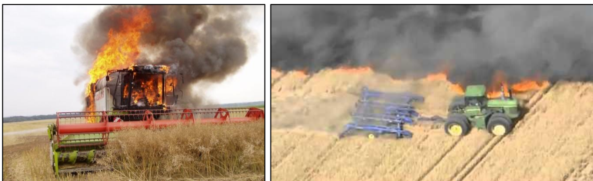
Figura 3 Incendiu la o combină de recoltare a rapiței (Černek, 2015 ww.sme.sk) și atenuarea răspândirii focului cu unelte de prelucrare a solului de mică adâncime (www.youtube.com)
