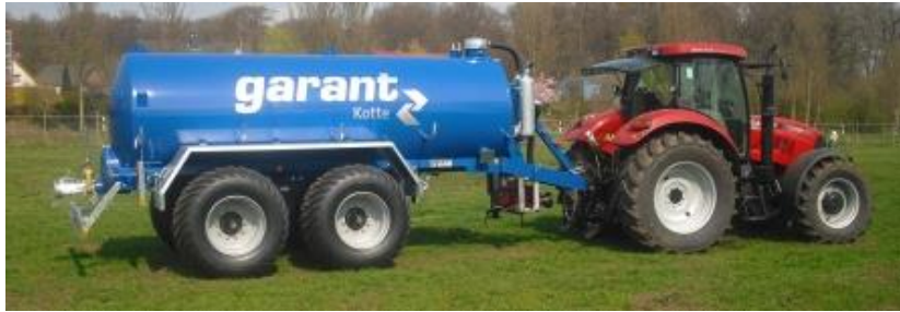
Figura 1 Tractor și remorcă pentru prevenirea răspândirii focului de vegetație (www.ematechtechnologie.sk)
